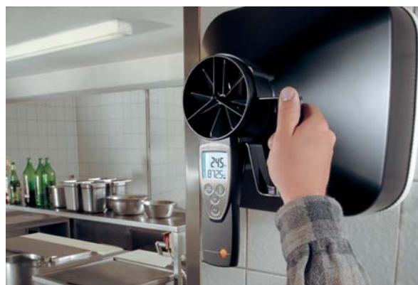
testo 417 - för mätning över väggmonterad frånluftsfläkt
